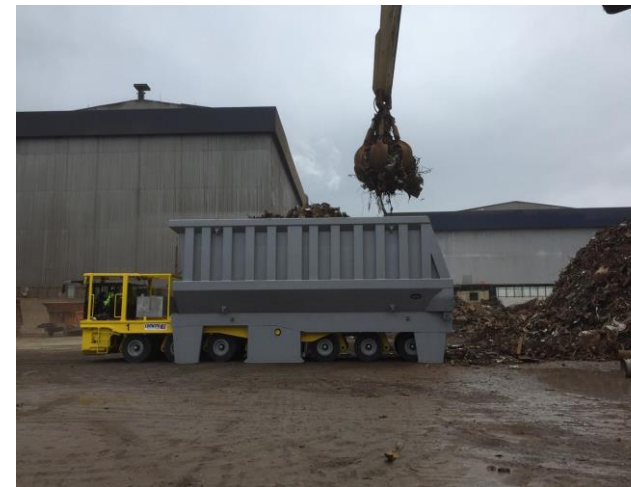
Esimerkki mahdollisesta kuljetusratkaisusta terästehtaalte, jossa hyödynnetään SPMT-siirtoajoneuvoa
